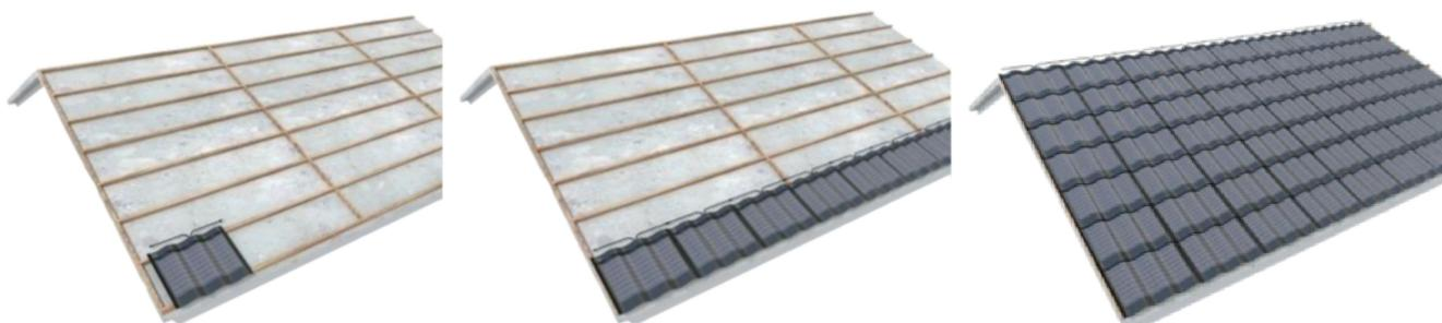
Para o acabamento lateral, superior ou inferior do telhado podem ser utilizadas as **telhas auxiliares**, fabricadas em cerâmica, com a mesma cor e encaixes laterais. São utilizadas **3 Telhas Auxiliares para cada telha solar**.
