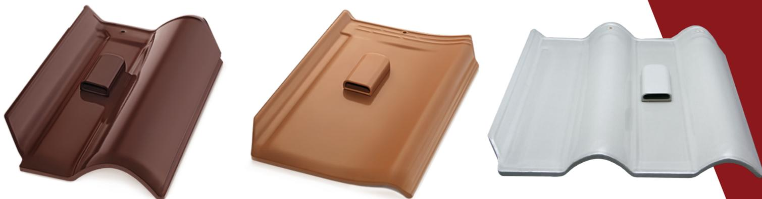
**A instalação** deve ser de forma "aleatória", espaçando-se as telhas ventiladas a cada 1,50 ou 2,00m de distância uma(s) da(s) outra(s), conforme pretensão de ventilação, de forma intervalada com as telhas cerâmicas.
