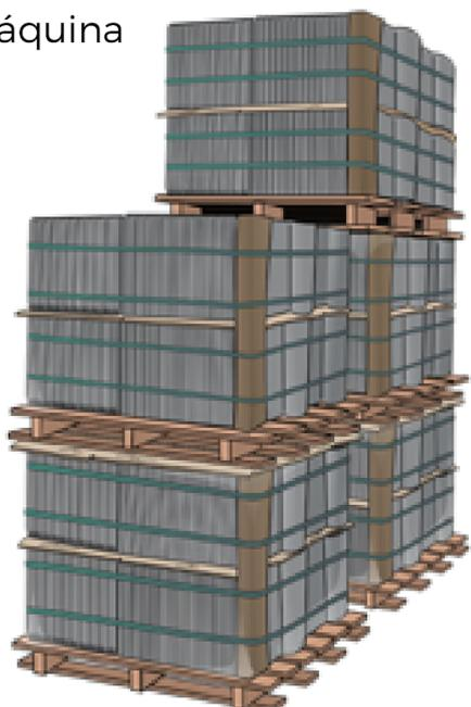
Caso a descarga seja com empilhadeira ou caminhão munck, observar que o contra piso deve ser adequado (peso e nivelamento) ao empilhamento. Caso seja manual, observar a altura e formação das pilhas para evitar que fiquem tortas e danifiquem o material. Recomendamos o uso de proteção entre as pilhas das peças, para evitar avarias.
