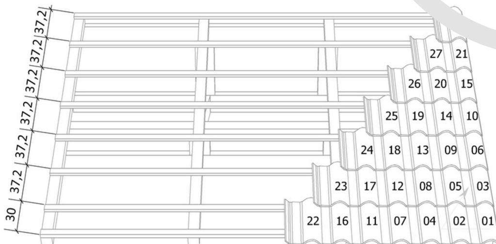
Uma atenção especial deve ser dedicada ao **"alinhamento vertical" das telhas**, pois desalinhamentos podem promover o estrangulamento do canal e impedir a passagem d'água, resultando no transbordamento pela aba.
