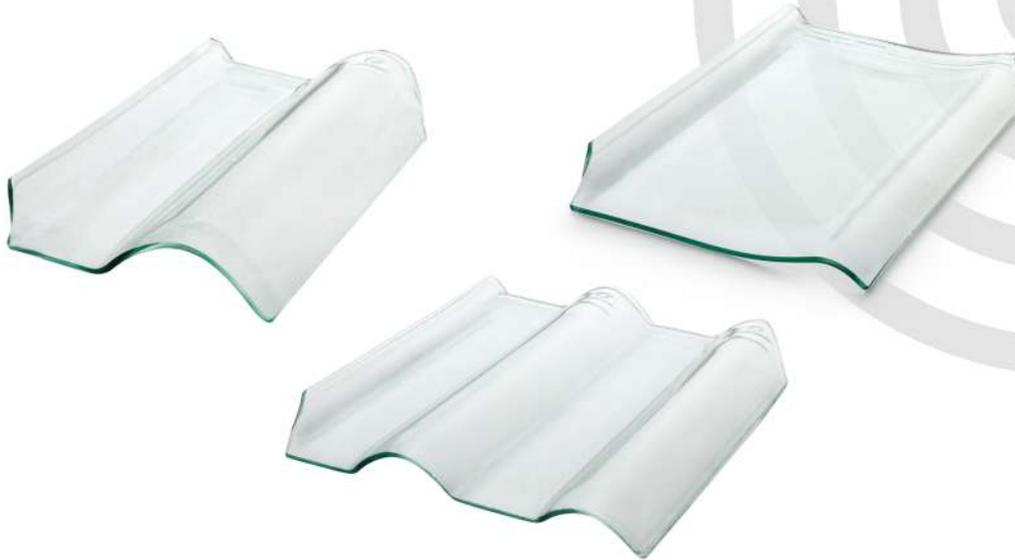
**A instalação** deve ser de forma "aleatória", espaçando-se as telhas translúcidas a cada 1,50 ou 2,00m de distância uma(s) da(s) outra(s), conforme pretenção de luminosidade, de forma intervalada com as telhas cerâmicas.
