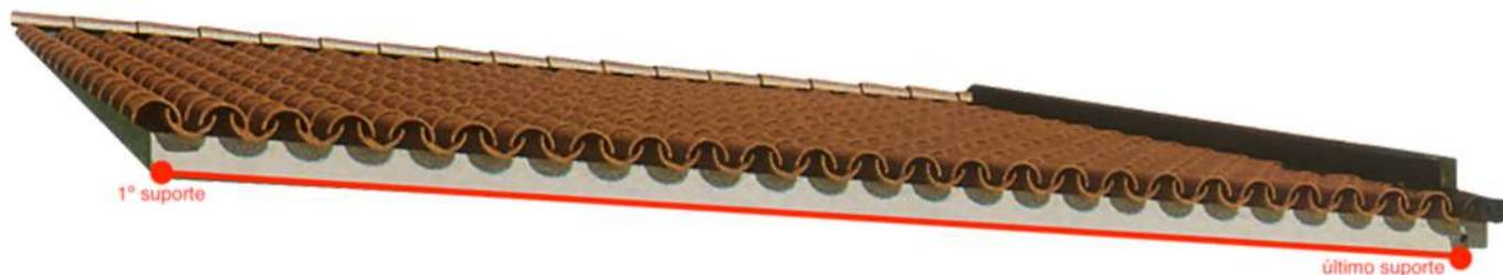
Com uma trena, faça as marcações onde serão instalados os suportes (1). Marque os pontos para fixação dos parafusos no caibro ou na parede (2). Com a ajuda da furadeira finalize a aplicação dos suportes (3).
