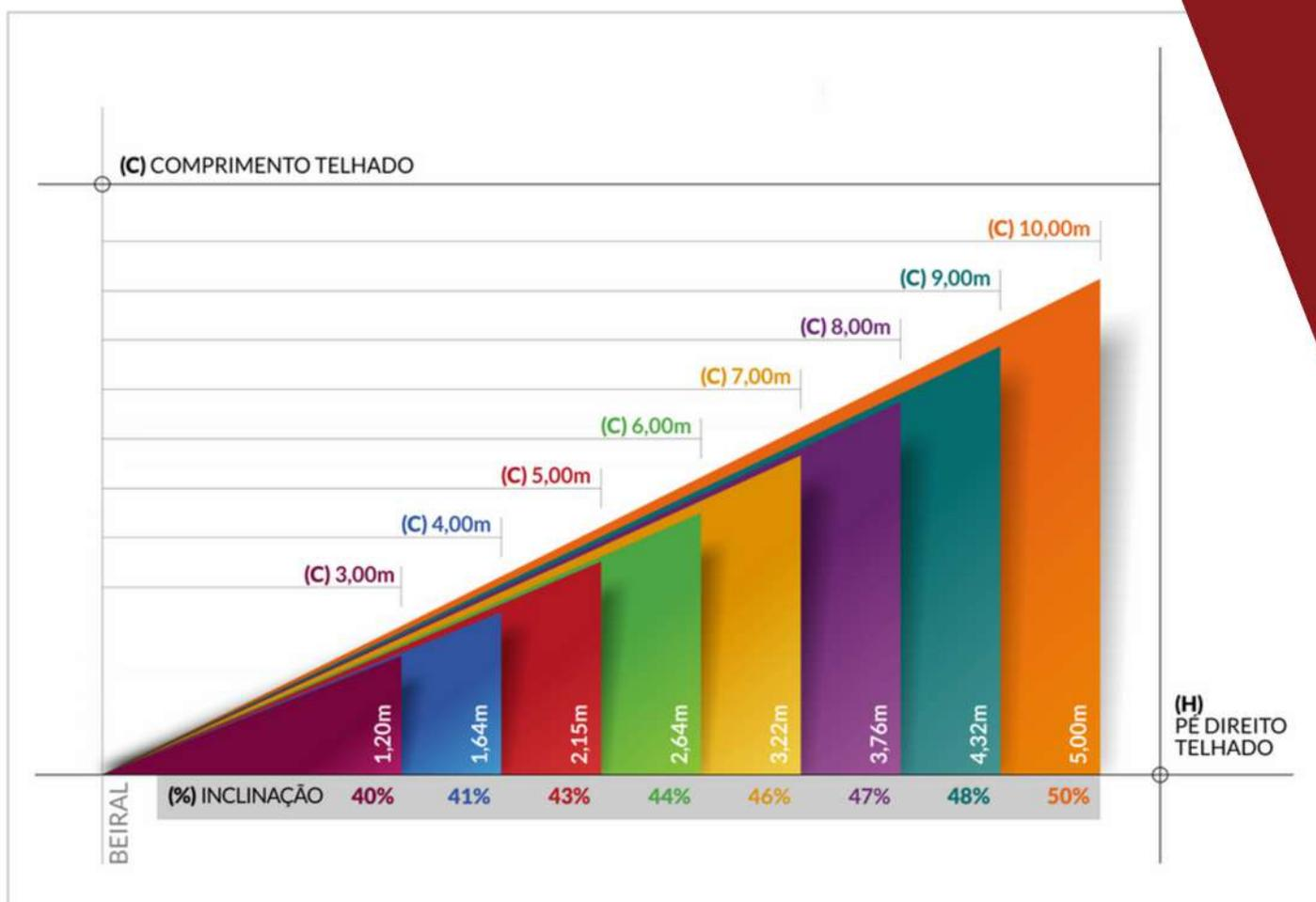
Nas regiões onde podem predominar **ventos fortes, construções em áreas descampadas, expostas** ou por **margem de segurança** adicional, recomenda-se que o telhado tenha uma **inclinação superior a 45%**.
