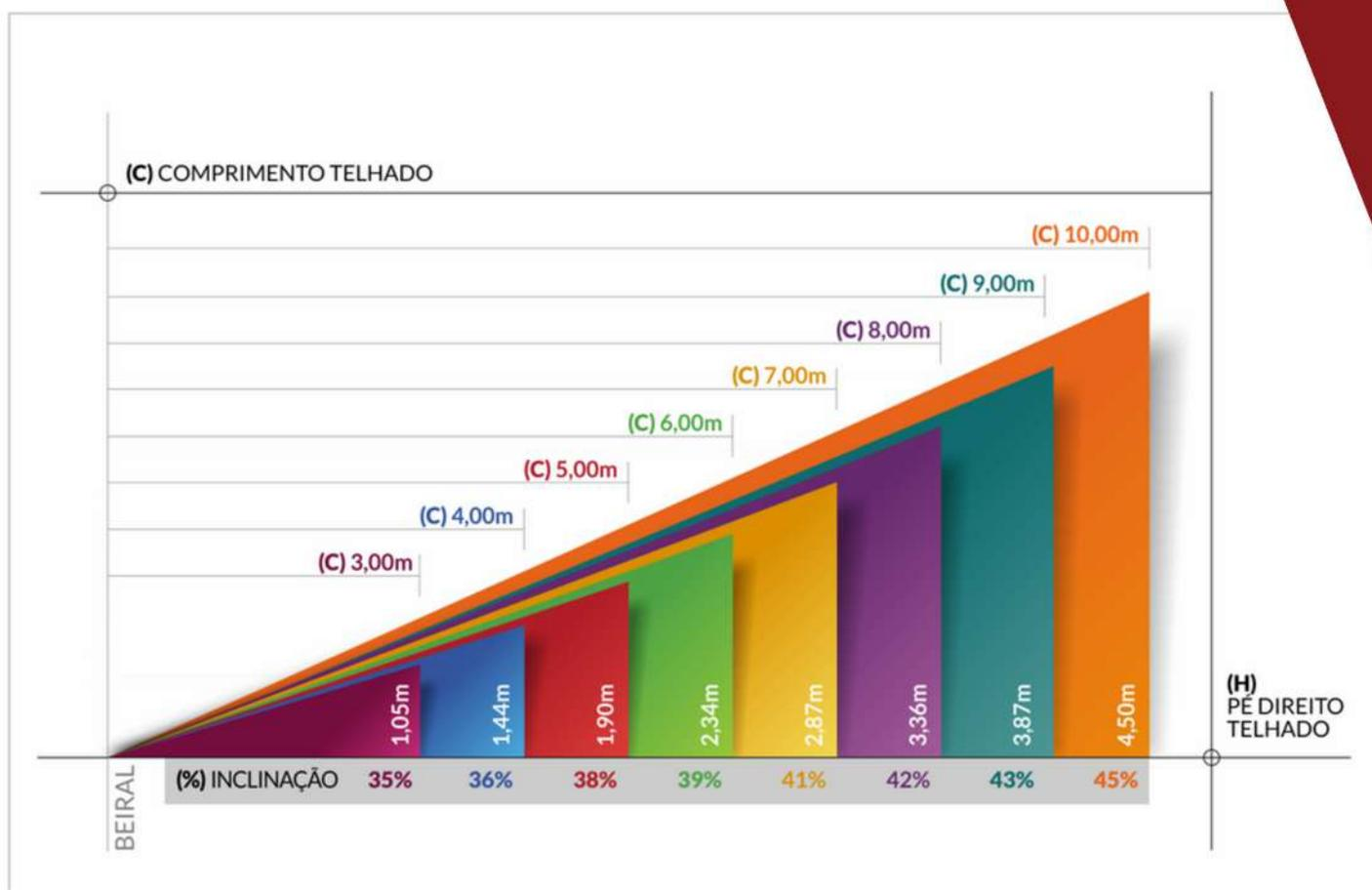
Nas regiões onde podem predominar **ventos fortes, construções em áreas descampadas, expostas** ou por **margem de segurança** adicional, recomenda-se que o telhado tenha uma **inclinação superior a 45%**.
