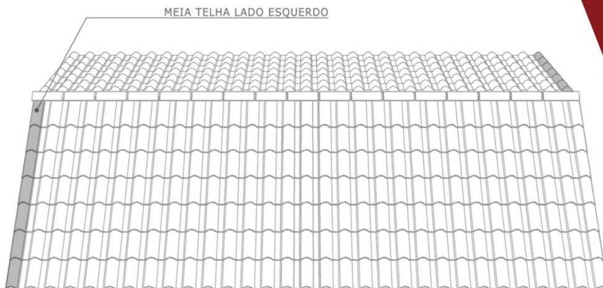
**ATENÇÃO!** Se for necessário fazer o corte da telha ou efetuar as furações para fixação, deve-se evitar fazê-lo sobre o telhado, pois o pó da cerâmica pode impregnar na superfície esmaltada dificultando a limpeza, além de gerar acúmulo de material.
