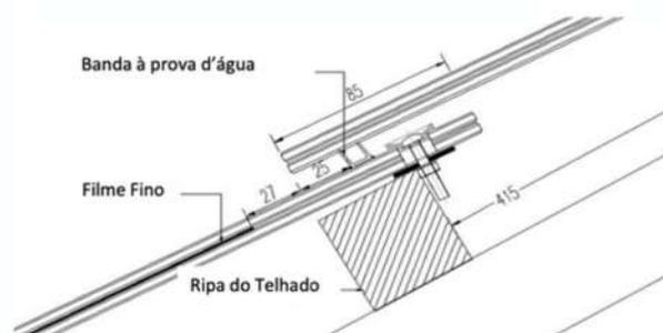
O assentamento sobre as ripas, deste modelo, deve ser iniciado da esquerda para a direita, conforme imagens abaixo.
